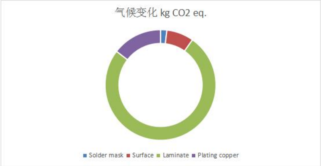
图 2 印刷电路板-零部件生产过程贡献分析
