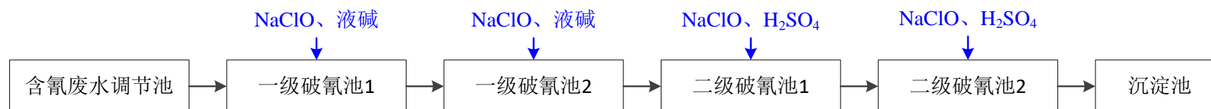
图4-4 含氰废水预处理系统工艺流程图
