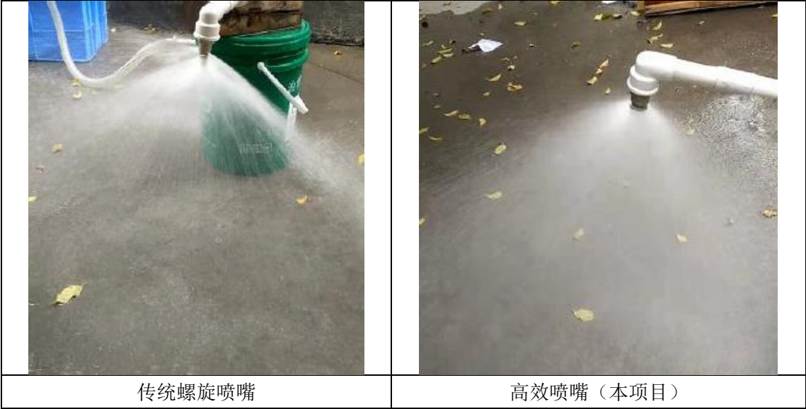
图1.7-2 传统螺旋喷嘴与本项目使用的预处理捕捉塔的喷嘴对比示意图
