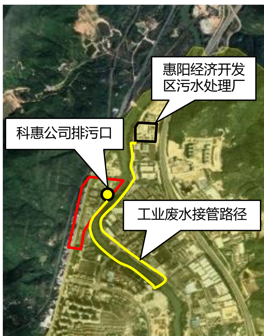
图2 项目废水进入惠阳经济开发区污水处理厂的接管路径图
