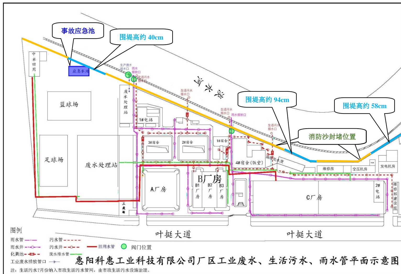
图3 项目事故应急池、雨污管网及事故时围堵位置图
